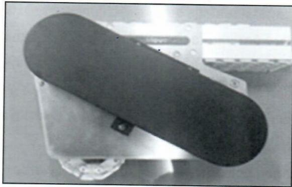
Abdeckung des Antriebs zur Abdeckung des Kettendurchhangs des hängend montierten Antriebs
