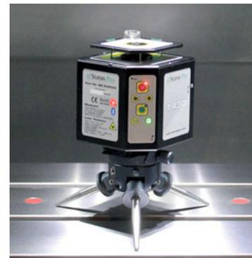
Das sehr universelle Adapterpaket bietet Befestigungslösungen für fast jede Vermessung. Egal ob Sie den Laser per Magnet, Stativ oder Winkeladapter auf, neben oder unter der Maschine befestigen, hier finden Sie immer die passende Lösung.
