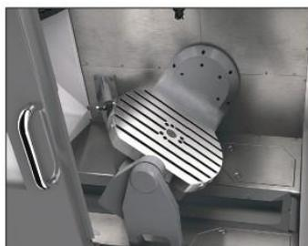
Der integrierte Dreh-/Schwenktisch der UMC-750 kann die Werkstücke in fast jedem Winkel zur fünfseitigen (3 + 2) Bearbeitung positionieren bzw. eine simultane 5-Achsen-Bewegung für die bahngesteuerte Bearbeitung und komplexe Abläufe ausführen.
